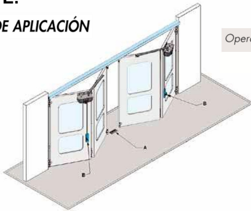
Operador montado en la pared, por encima o por debajo de la guía, abiertura posible a más de 120°
