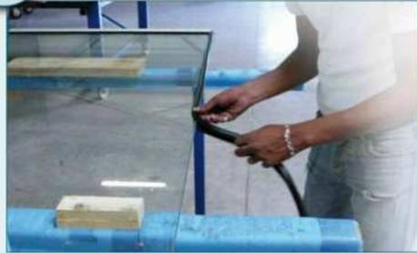
**4.1** Cortar la junta a altura del bastidor. Cortar todo recto siguiendo el labio de la junta únicamente en el caso de un acristalamiento de 10 mm.
