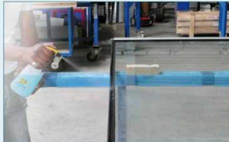
**4.3** Lubricar el exterior de la junta (parte superior y fondo) con el vaporizador.
