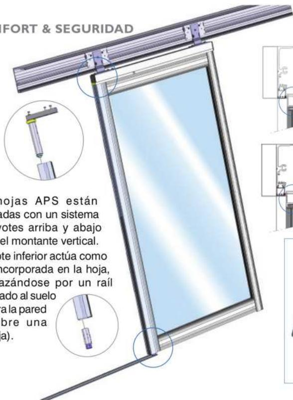
Las hojas APS están equipadas con un sistema de pivotes arriba y abajo sobre el montante vertical. El pivote inferior actúa como guía incorporada en la hoja, desplazándose por un raíl guía fijado al suelo y contra la pared (o sobre una hoja fija).
