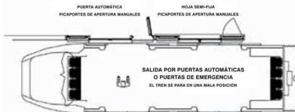
El módulo de la puerta se compone de 2 puertas automáticas (lado izquierdo y lado derecho). Cada una de ellas es arrastrada por un potente operador DIVA, adaptado para este tipo de proyecto específico.
