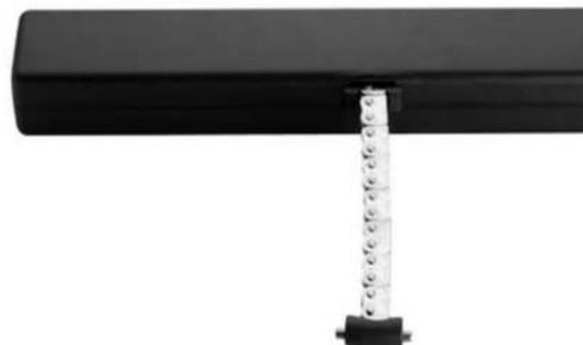
Actuador eléctrico Topp modelo C20 con cadena articulada de doble eslabón contenida en funda, dotado de soporte y accesorios para la apertura proyectante o abatible. Funcionamiento a 24VDC. Carga máxima aplicable 300 N. Enganche de conexión rápida a la ventana. Carrera regulable desde el exterior mediante interruptor de selección con topes a 240 y 360 mm. Aparato con marca CE.
